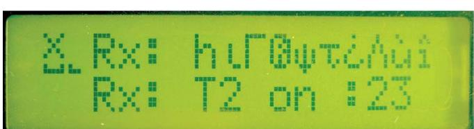
Slika 4: Prikaz slabega sprejema na LCD displeju.
